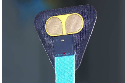
(d) Laminated capacitive sensor (Clothing + and T.U. Berlin)
